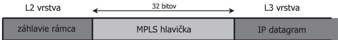
Obr. 4: Umiestnenie MPLS hlavičky v rámci
