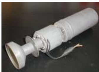
Príklad klasického "starého" LNB, kde ožarovač a polarizér sú na vstupe
